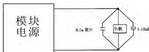
图3 负载去耦电路
